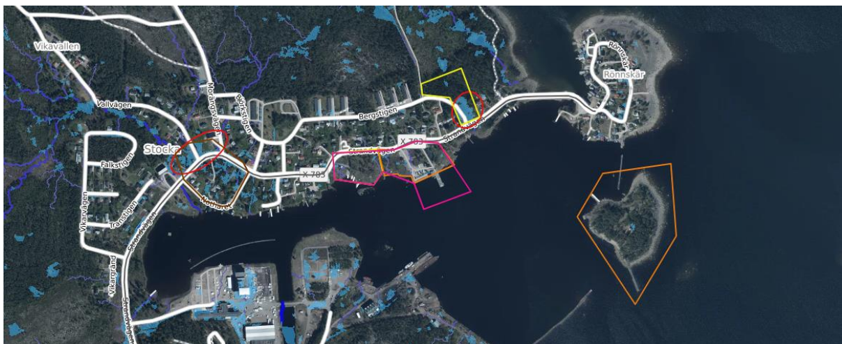
Figur 3. Figur över Stocka och Stockaviken tagen från SCALGO med indata från GIS som visar skyfallskartering. Röda cirkelna illustrerar potentiella riskområden.
